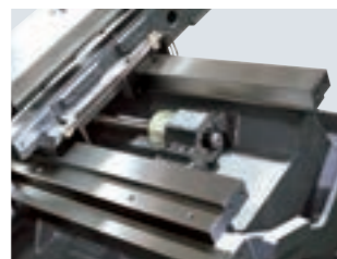
// Box Way Slant Bed Structure
